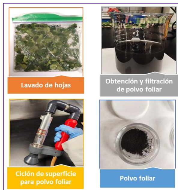
Figura 1. Lavado de hojas y obtención de polvo foliar mediante un ciclón de superficie.
