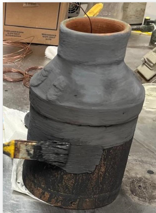
Fig. 3. Fijación de pasta Zn/Cu/grafito en superficie exterior del recipiente de barro como cátodo de aire.
