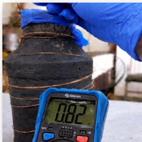
Fig. 5. Registro de voltaje a circuito abierto en CCM con cátodo de aire.
