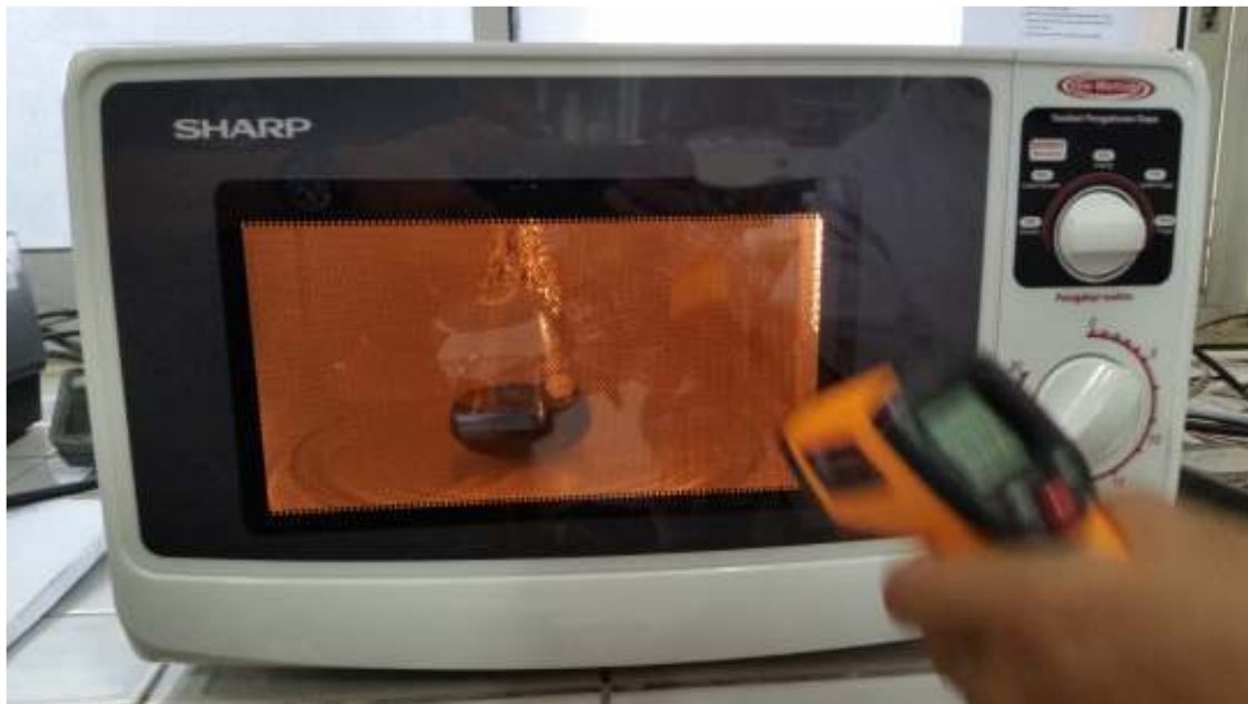
Proses Transesterifikasi dengan Microwave
