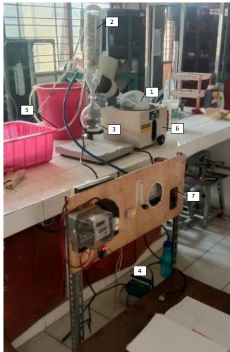
Gambar 2. Rangkaian alat eksperimen RVE dengan sistem kontrol otomatis berbasis panel pengatur. Komponen utama: (1) labu evaporasi, (2) kondensor vertikal, (3) labu penampung, (4) pompa vakum, (5) pompa sirkulasi air pendingin, (6) water bath dan (7) panel kontrol
