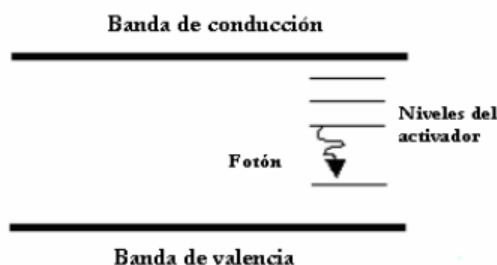
Fig. 17: Estructura de bandas de un material centellador entre la banda de conducción y banda de valencia.
