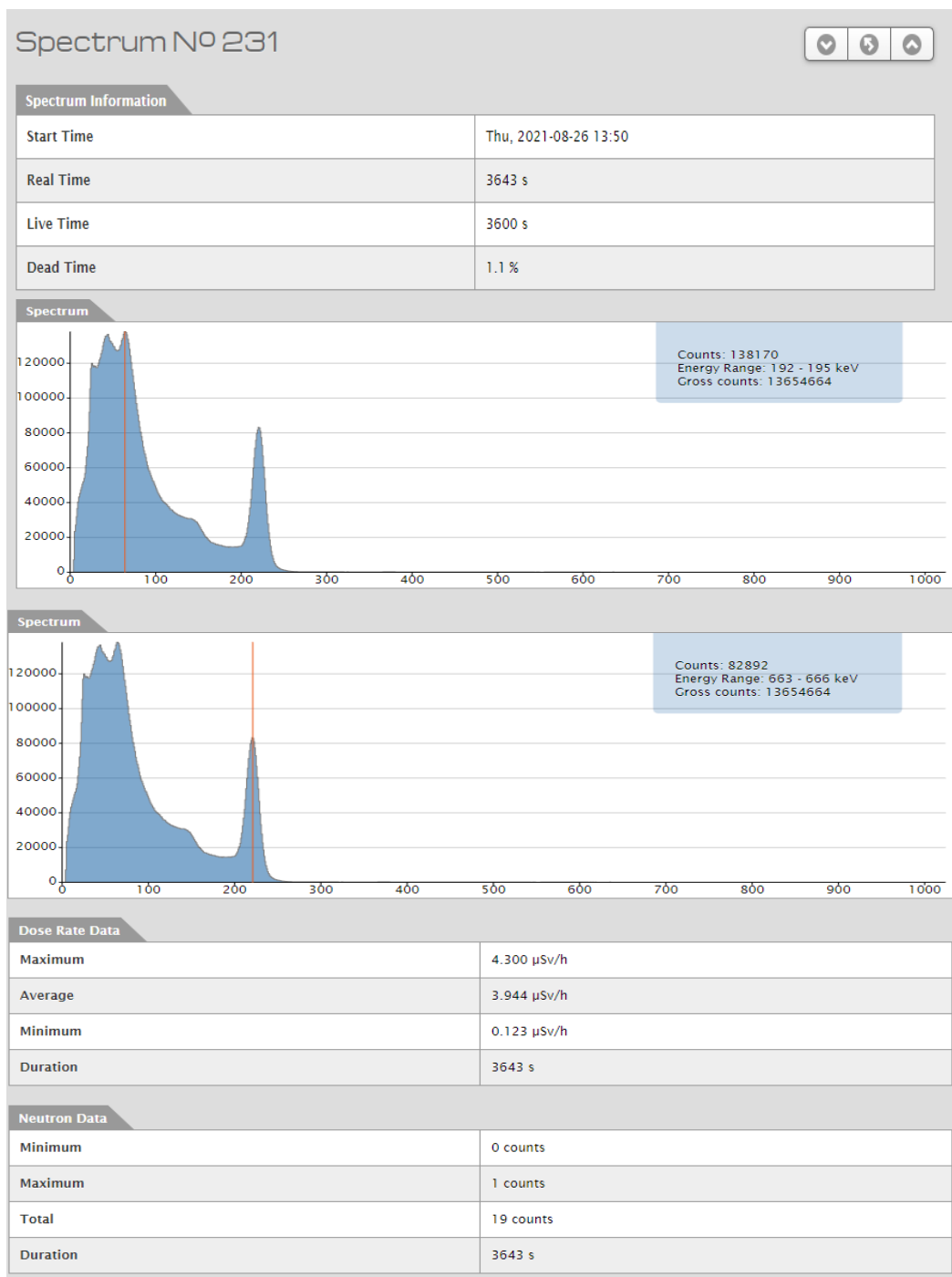
Fig. 51: Espectro 231 – Espectro con fosfito en recipiente de icopor, con presencia de la fuente de Cs-137
