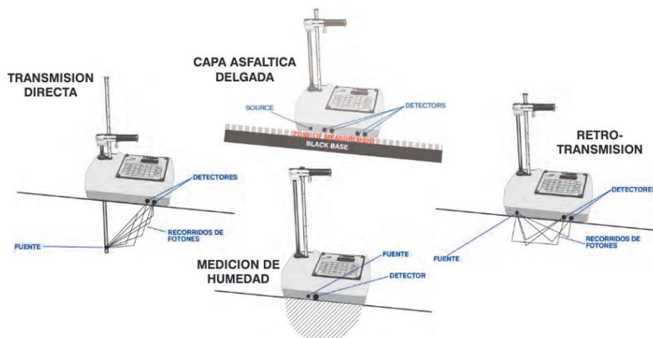
Fig. 1: Esquemas de funcionamiento de densímetros nucleares – Figuras de manual de densímetros nucleares marca troxler modelo 3440. www.troxlerlabs.com
