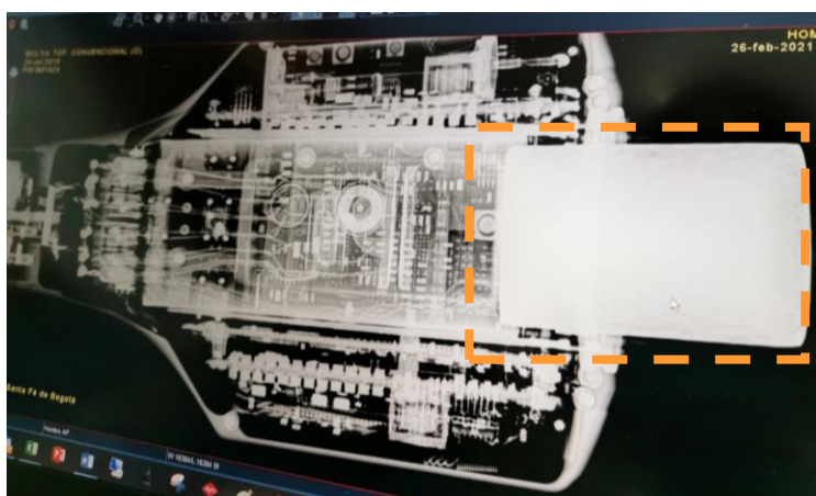
Fig. 20: Tomografía realizada al equipo Identifinder, con la cual se confirmó las dimensiones del cristal de NaI la cual se encuentra señalada en la línea punteada naranja
