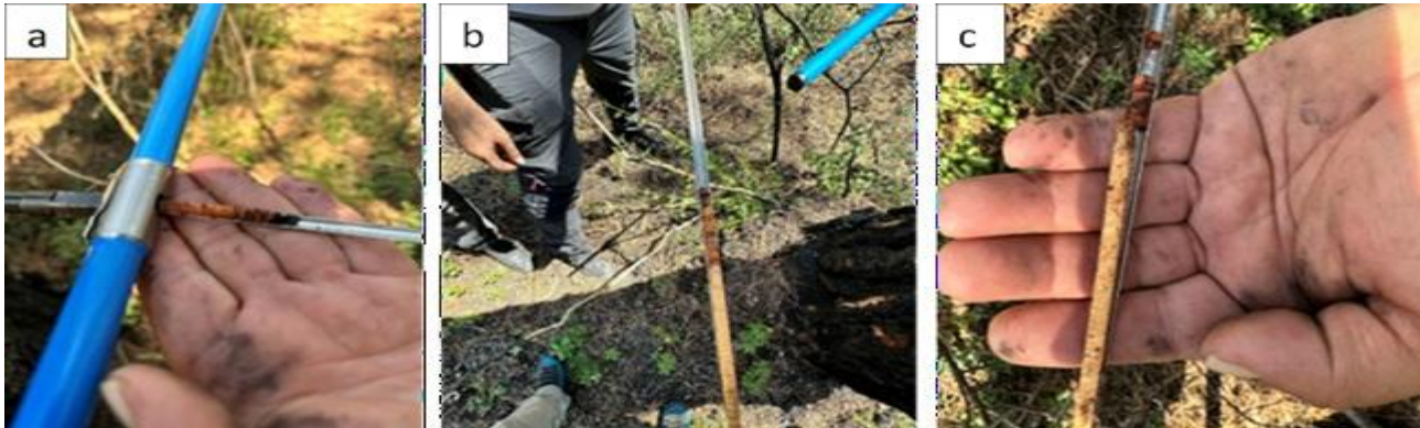
Şekil 6. Artım burgusu (a) ile artım kalemi alma (b) ve kambiyum zararı tespiti (c)
