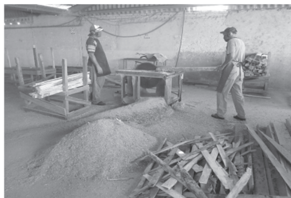
Figura 1. Acumulación de residuos en la carpintería.
