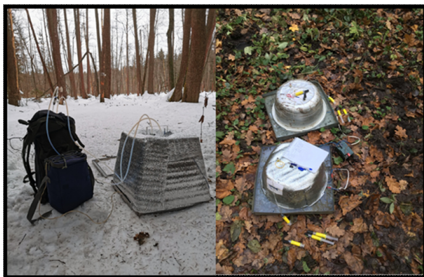
Рис. 6. Статический камерный метод в действии; слева – газовый анализатор Licor 7810 подключен к камере в форме усеченной пирамиды; справа – камеры не подключены к газоанализатору (отбор проб осуществляется при помощи шприцев)
