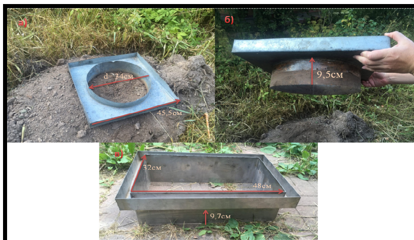
Рис. 5. Основания для камер: а, б) из оцинкованной стали; в) из нержавеющей стали
