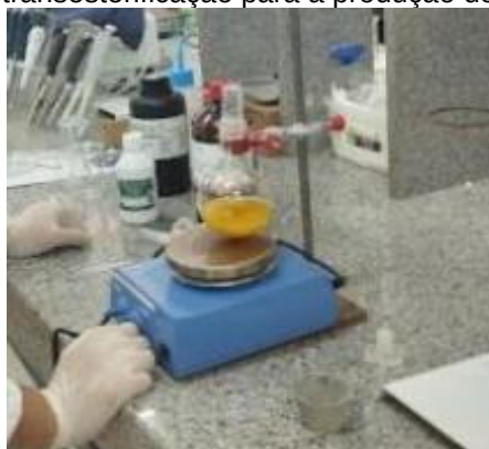
Figura 4. Reação de transesterificação para a produção do biodiesel de cártamo
