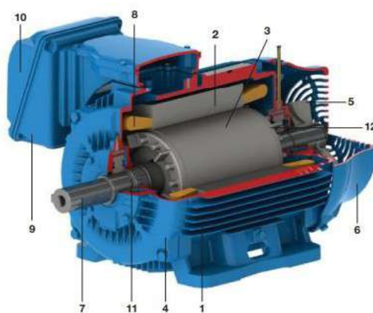
Figura 4 – Motor de Indução Trifásico com rotor gaiola de esquilo
