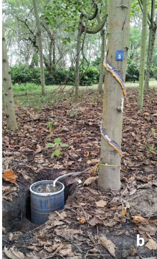
Figura 10. Pluviómetros para cuantificar la precipitación en plantaciones forestales. a. Pluviómetro en abierto; b. Pluviómetro cortical; c. Pluviómetro lineal. Fotos: Jhon Jairo Zuluaga Peláez
