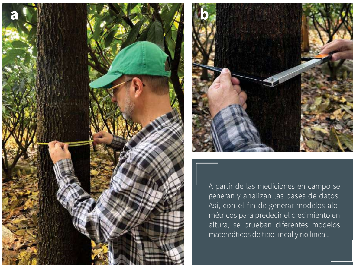
Figura 4. Medición del DAP. a. Medición con cinta diamétrica; b. Medición con forcípula. Fotos: Diana Catalina Cervera
