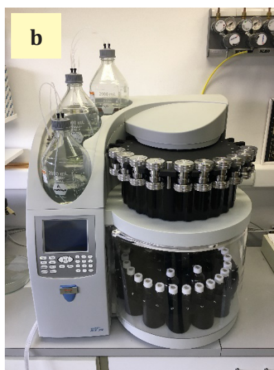
Slika 7: (a) Ekstrakcija odvzetih vzorcev lesa rdečega bora ( Pinus sylvestris L.) in robinije ( Robinia pseudoacacia L.) je potekala v aparatu Soxhlet. Ekstrakcijski proces smo podprli s (b) sistemom za pospešeno ekstrakcijo Thermo Scientific™ Dionex™ ASE™ 350. (c) LC sistem Interchim puriFlash PF-XS 520 Plus avtomatsko frakcioniranje in purifikacijo ekstraktov skorje in lesa (foto: V. Vek).
