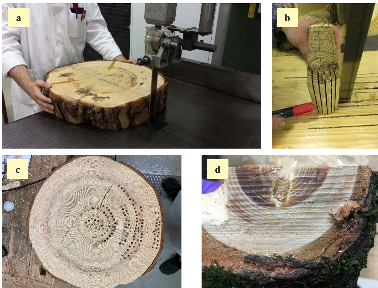
Slika 6: (a) Vzorčenje lesa iz debelnega koluta in (b) vzorčenje jedrovine robinije v radialnem nizu s tračnim žagalnim strojem. (c, d) Vzorčenje lesa debela in grč s svedrom. Vzorčenje lesa iz (c) kolotov s svedrom je predvsem hitrejša v primerjavi z (a) razžagovanjem kolotov na tračnem žagalnem stroju. Na sliki (d) vidna sled svedra, s katerim smo vzorčili temno obarvana in z ekstraktivi impregnirana lesna tkiva veje (foto: P. Oven in V. Vek).
