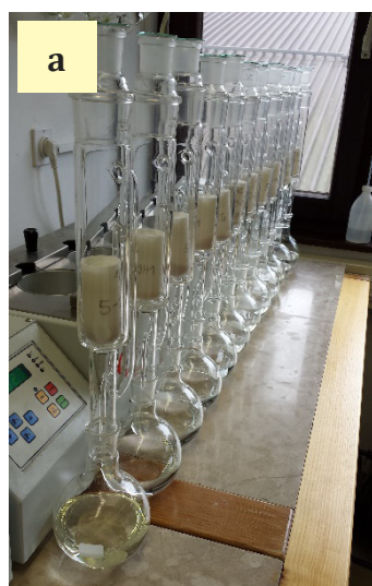
Slika 7: (a) Ekstrakcija odvzetih vzorcev lesa rdečega bora ( Pinus sylvestris L.) in robinije ( Robinia pseudoacacia L.) je potekala v aparatu Soxhlet. Ekstrakcijski proces smo podprli s (b) sistemom za pospešeno ekstrakcijo Thermo Scientific™ Dionex™ ASE™ 350. (c) LC sistem Interchim puriFlash PF-XS 520 Plus avtomatsko frakcioniranje in purifikacijo ekstraktov skorje in lesa (foto: V. Vek).
