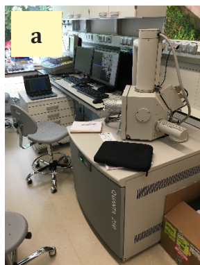
Slika 10: Z ekstraktivi impregnirane vzorce lesa smo preiskali s CLMS in (a) SEM mikroskopskimi tehnikami. Pred SEM analizo smo (b) poravnane površine vzorce prevlekli z zlatom, (c) SEM mikroskopiranje orientiranih vzorcev smo opravljali pri nizkem in visokem podtlaku (foto: V. Vek).
