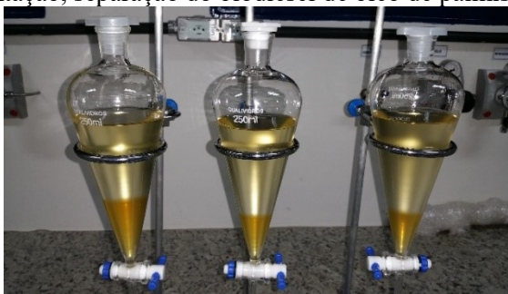
Figura 18 - Etapa de decantação, separação do biodiesel de óleo de palmiste da glicerina
