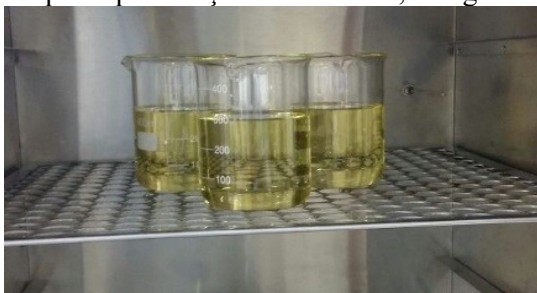
Figura 20 - Etapa de purificação do biodiesel, secagem em estufa a 105 °C
