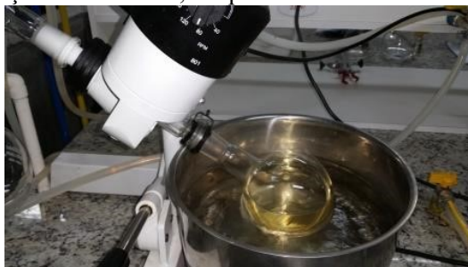
Figura 19 - Etapa de purificação do biodiesel, evaporador rotativo
