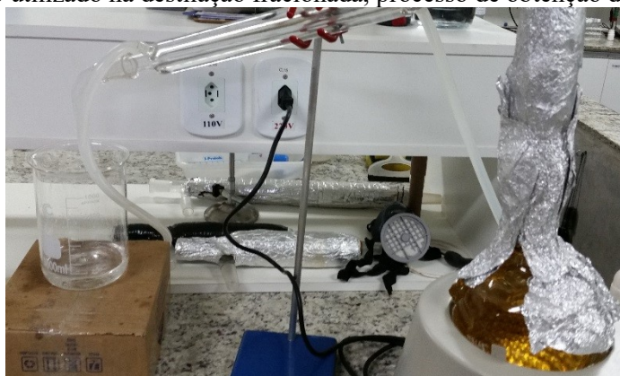
Figura 30 - Aparelho utilizado na destilação fracionada, processo de obtenção do biodiesel leve
