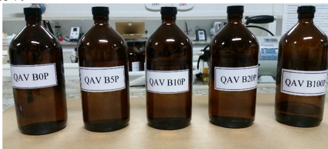
Figura 36 - Misturas de querosene QAV-1 com ésteres leves de biodiesel de óleo de palmiste, na proporção de 5, 10 e 20 %
