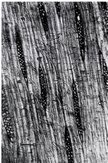
Fig. 2. Dendropanax arboreus , corte tangencial, línea de escala: 100 \mu m
