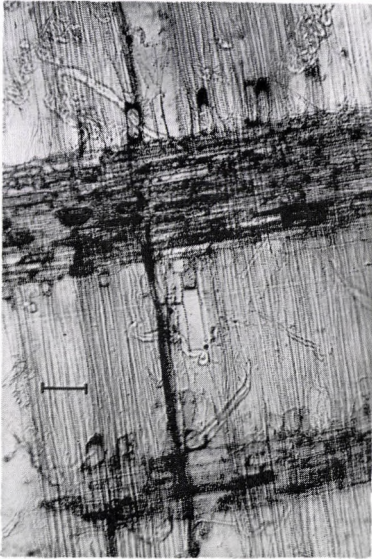
Fig. 9. Cinnamomum montanum , corte radial, línea de escala: 100 \mu\text{m}
