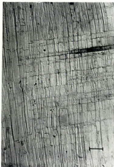
Fig. 6. Ochroma pyramidalis , corte radial, línea de escala: 100 \mu\text{m}
