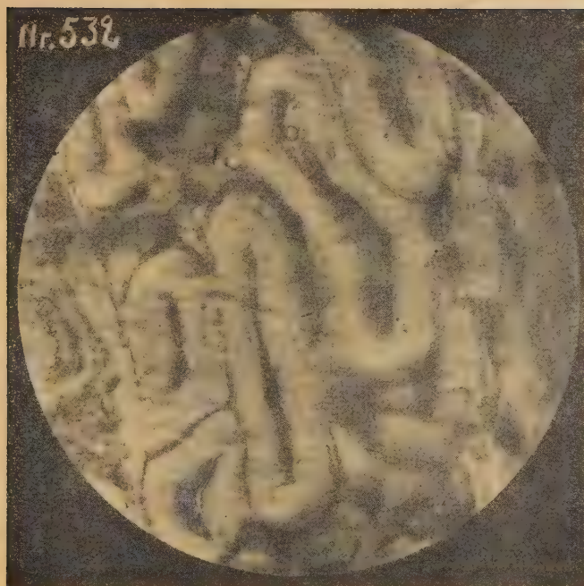
Fig. 7. Przekrój poprzeczny przez włókna sześciomiesięcznego rami (powiększenie 580-krotne). Mikrofotografia wykonana w Głównym Instytucie Włókiennictwa
