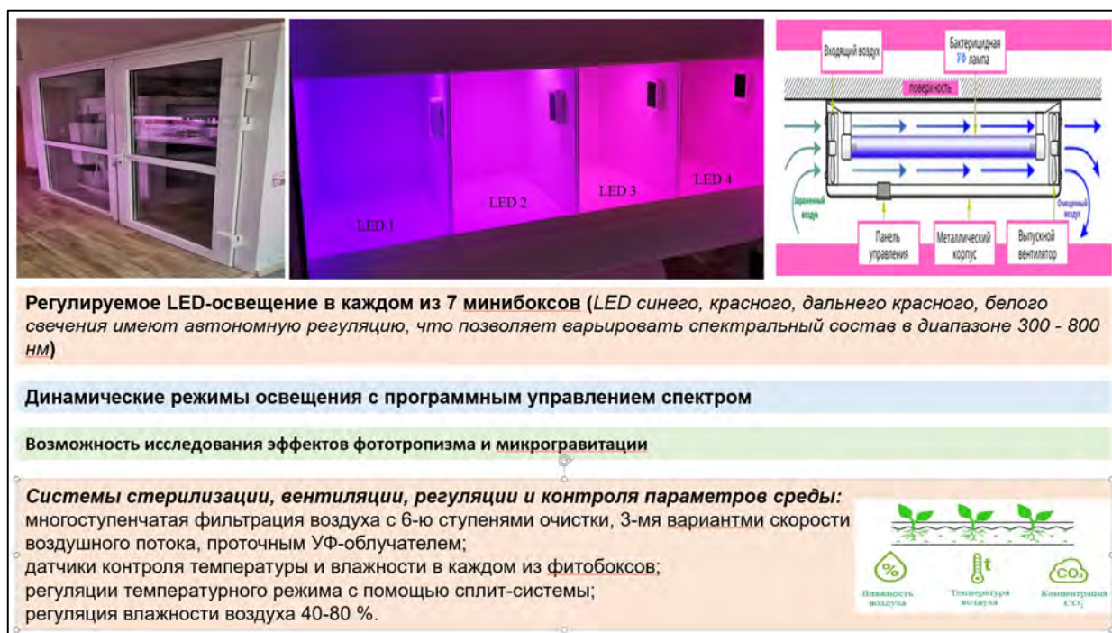
Рис. 2. Экспериментальная климатокамера с малогабаритными LED-фитоboxами
