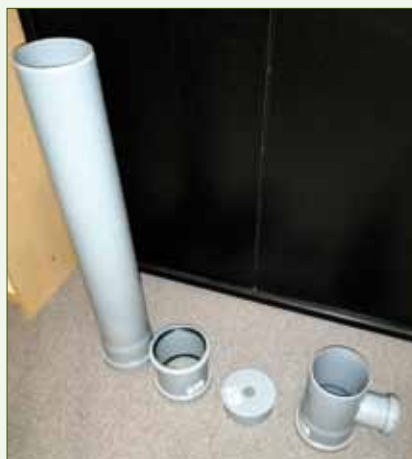
Von links nach rechts: Standrohr, Muffe, Stopfen mit Loch, Abzweig zur Schlauchdurchführung von Pumpe in Standrohr
