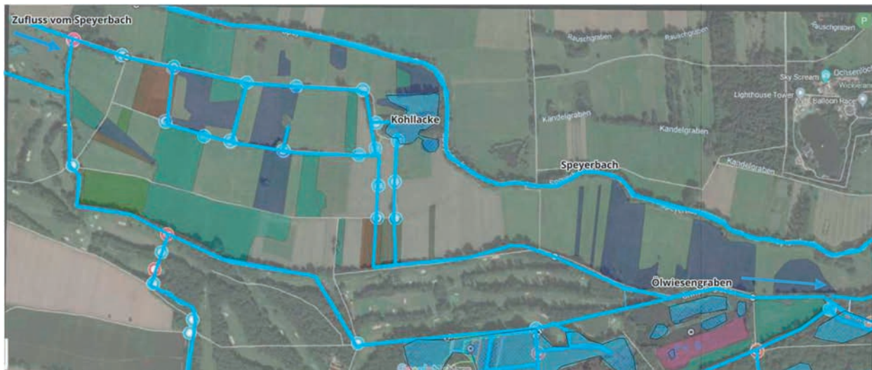
Abb. 22: Neu aktiviertes Bewässerungssystem im Bereich des NSG Lochbusch-Königswiesen: Das Wasser wird vom Speyerbach abgeleitet und kommt über einen Graben (oben links in der Karte) in das Gebiet und fließt verzweigt über viele Gräben nach Südosten weiter. Zentrale Teile der Wiesenfläche werden dabei über Seitengräben überflutet. Auch in der Kohllacke entsteht ein temporäres Gewässer (hellblaue Fläche). Ein Teil fließt dann in den Ölwiesengraben (am Südrand der Wiesenflächen unten rechts im Bild), ein anderer Teil in das Waldgebiet südlich der Wiesen. Hierdurch wird auch dieses Waldgebiet temporär großflächig überflutet. Eine Interaktive Karte mit vielen weiteren Informationen kann man hier Link 995 einsehen.
