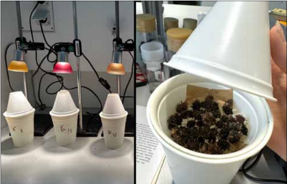
Abb. 3: Berlese-Apparatur zum Austreiben der in den Adelges-Gallen versteckten Arthropoden.
