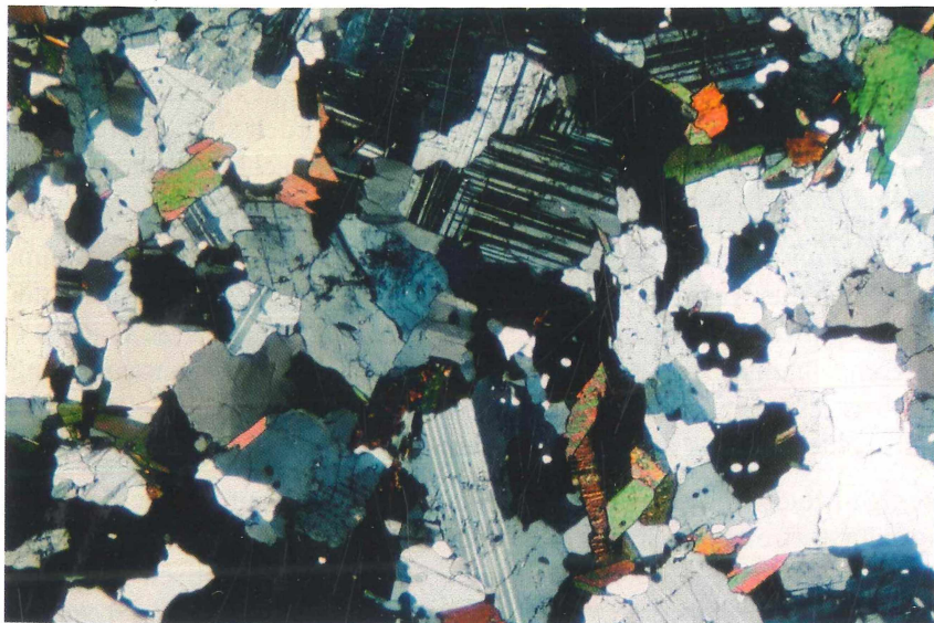
Abb. 10: Granit, Brocken/Harz; Dünnschliffbild unter dem Polarisationsmikroskop Mineralbestand: Quarz, Orthoklas, Natrium-Plagioklas, Biotit (bunt) Bildlänge: 2mm, gekreuzte Polarisatoren (Foto: W. Schneider)
