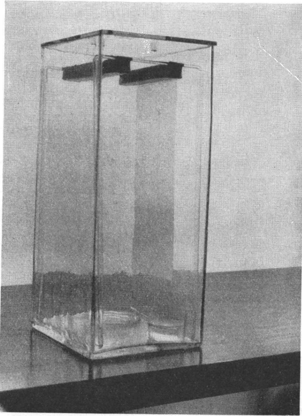
Fig. 1. Kromatografi-kar av glass. På bunnen av karret sees glass-skåler, som forsynes med de væsker som skal benyttes ved undersøkelsen, for å mette karrets atmosfære med væskenes damper. I karret er det hengt opp to kromatografi-«trau», i det ene er anbragt et kromatografipapir. På dette appliseres de stoffer som skal analyseres i den øvre enden — på høyde med trauets bunn. Når kromatografiprosessen begynner, fylles trauet med den organiske del av væskeblandingen. Denne vil da trekke seg gjennom kromatografipapiret og føre med seg de appliserte stoffer. Disse vandrer som runde flekker og går desto lenger, jo større deres oppløselighet i den bevegelige (organiske) del av væskeblandingen er i forhold til i den stasjonære (vandige) del.
