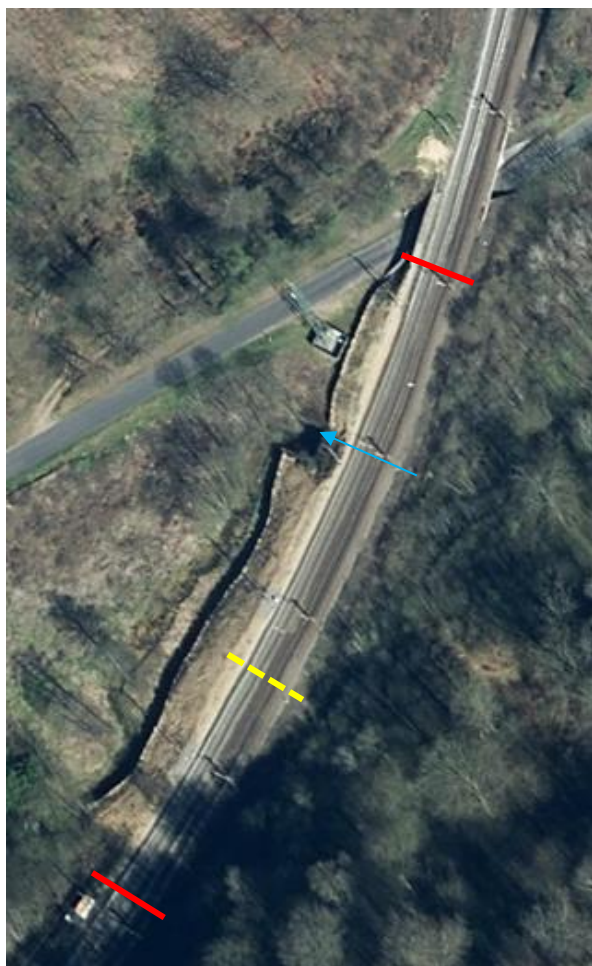
Fig. 1. – Orthophoto du 15 avril 2015 montrant le segment de la ligne ferroviaire : du sud du pont sur la route vers Lahage jusqu'à la cabine (traits rouges). La Chevratte passe sous le chemin de fer au niveau de la flèche bleue puis longe vers le sud le mur de soutènement en gros blocs de grès. Le trait jaune indique la limite entre les deux parties du segment (Source : Géoportail de Wallonie du SPW).
