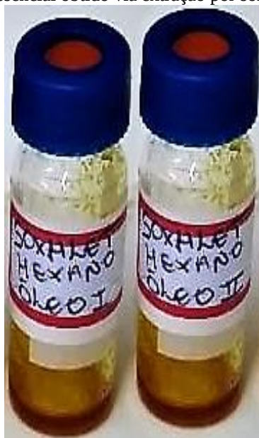
Figura 7 – Óleo essencial obtido via extração por solvente com Soxhlet
