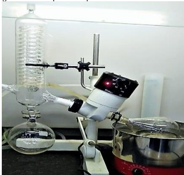
Figura 6: Rotaevaporador separando hexano do óleo essencial
