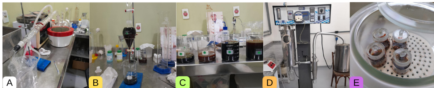
Figura 1: Etapas do processo experimental de extração de cafeína em diferentes frações do guaraná. (A) preparo das amostras; (B) montagem do sistema experimental; (C) maceração hidroalcoólica; (D) processamento das amostras; (E) separação dos extratos.
