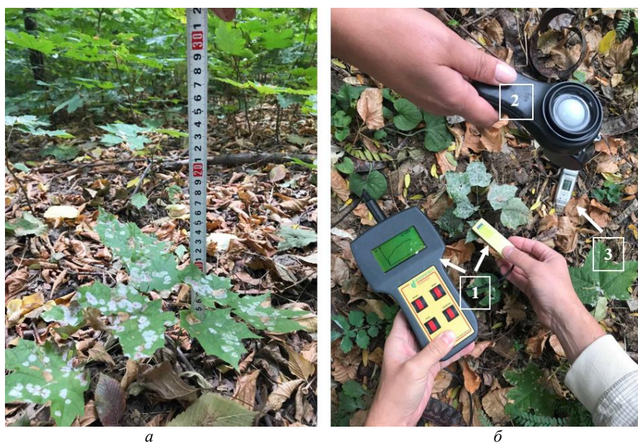
Рис. 1. Піддослідні паростки A. platanoides (а) та прилади для виміру параметрів фотосинтезу (б): 1 – портативний флуорометр «Флоратест» (Україна, 2016); 2 – люксметр PCE-174 (PCE Instruments, Німеччина, 2018); 3 – термометр HE-173 (HUATO ELECTRONIC CO.LTD, КНР, 2018)
