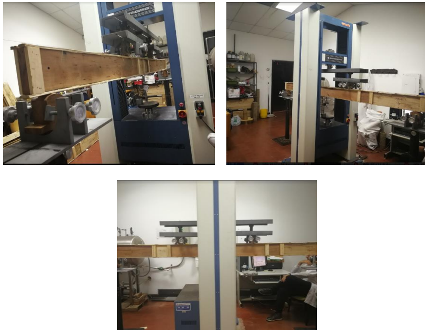
Figura 62. Montaje ensayo de flexión.
