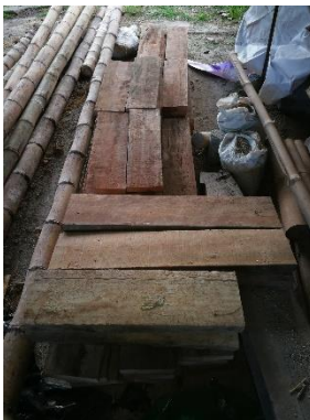
Figura 11. Acopio de madera seleccionada luego de retirar elementos metálicos y defectos.
