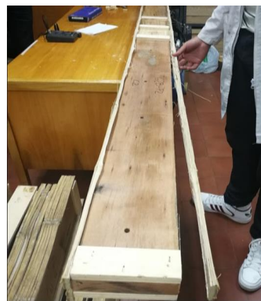
Figura 111. Falla por esfuerzos de tensión en la esterilla de la parte inferior y fallas en la línea de cola del patín inferior
