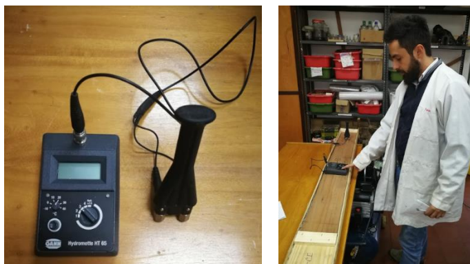
Figura 46. Mediciones de contenidos de humedad para la madera reutilizada.
