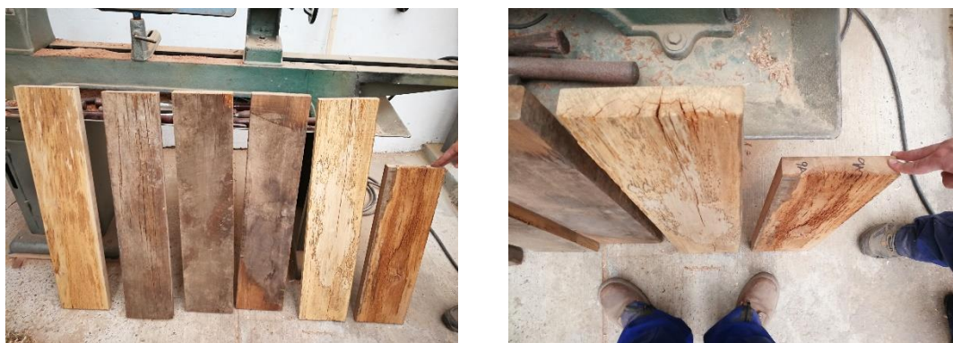
Figura 16. Madera descartada durante el proceso de cepillado.
