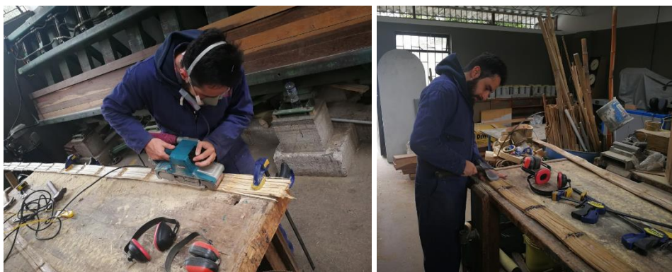
Figura 33. Retiro del tejido parenquimático y ramas en la parte exterior de la Guadua Angustifolia Kunth
