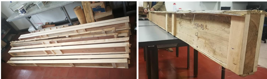
Figura 45. Curado de vigas
