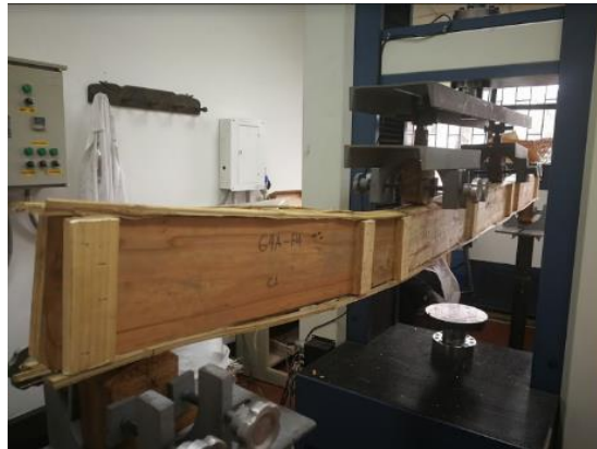
Figura 110. Deformación de la viga durante el ensayo de flexión.
