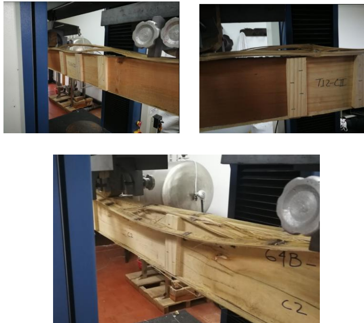
Figura 109. Falla en la línea de cola de la parte superior de la viga.
