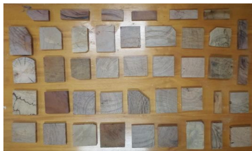
Figura 17. Muestras de las especies de madera reutilizada para caracterización macroscópica.
