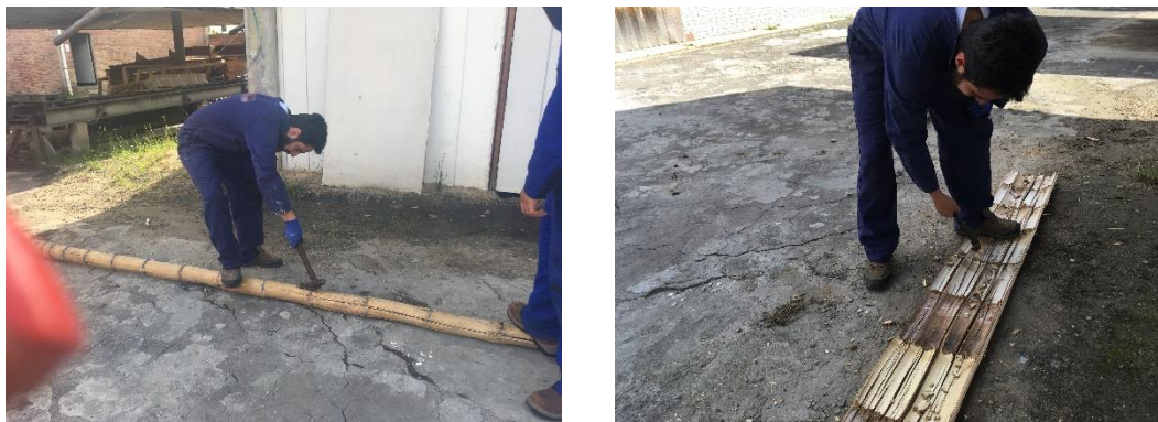
Figura 32. Proceso de fabricación de esterilla de Guadua angustifolia kunth
