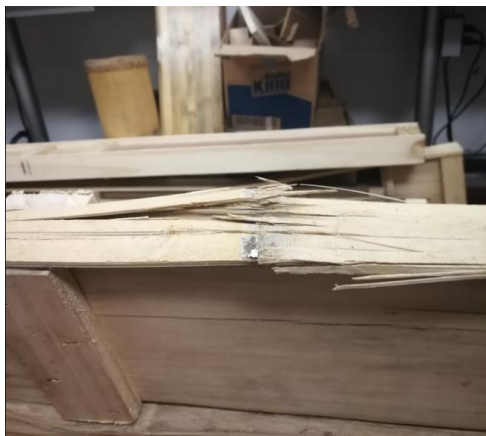
Figura 111. Falla por esfuerzos de tensión en la esterilla de la parte inferior y fallas en la línea de cola del patín inferior
