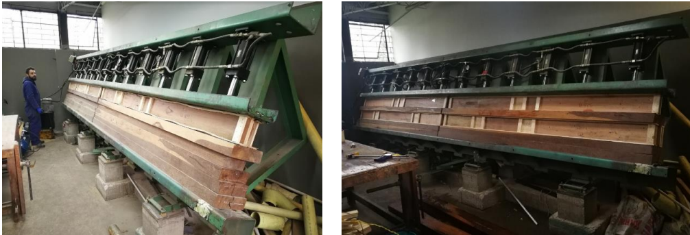
Figura 44. Prensado de vigas.
