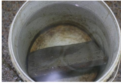
Gambar 9. Uji daya serap air papan
