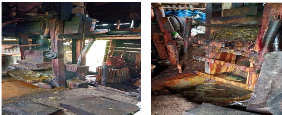
Gambar 2. Proses Pengempaan dengan menggunakan Dongkrak
