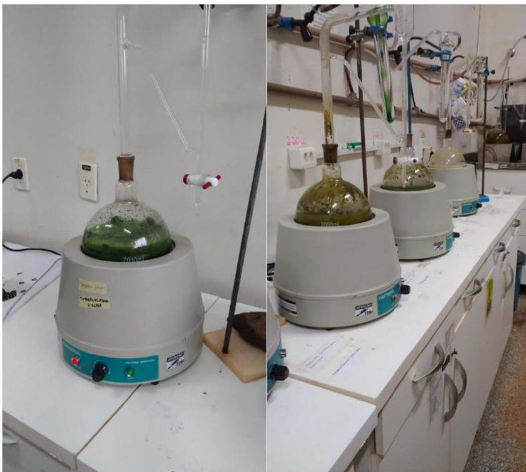
Figura 2. Aparelho de Clevenger promovendo a hidrodestilação Piper arboreum e Piper fuligineum
