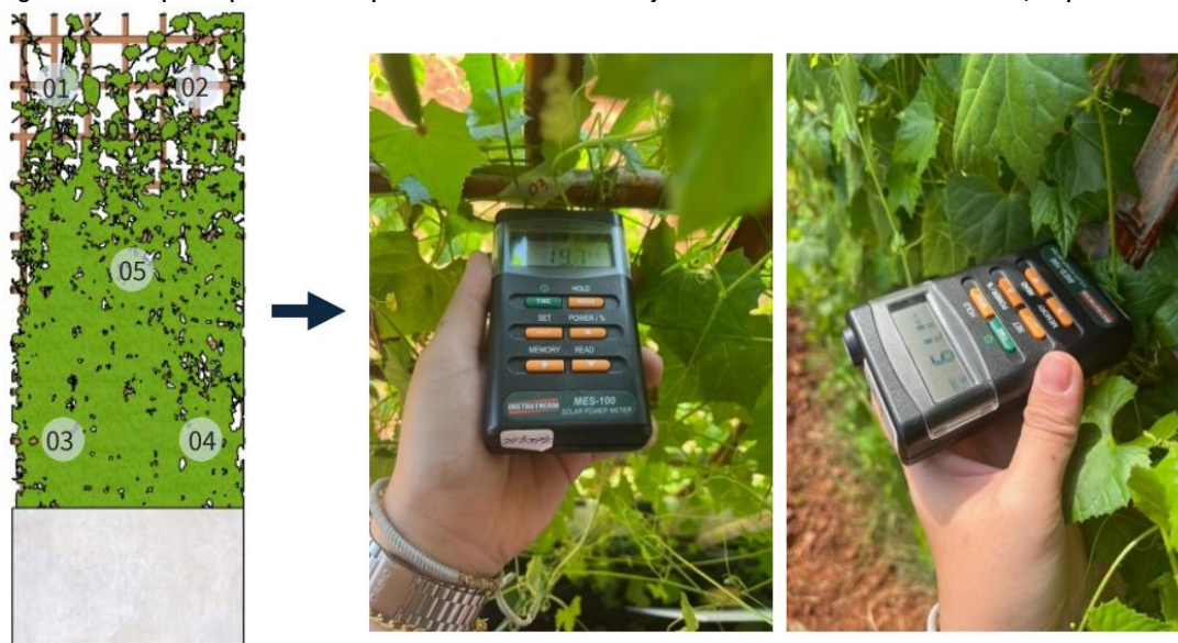
Figura 7 – Da esquerda para a direita: pontos estabelecidos e medição realizada na face interna e externa, respectivamente
