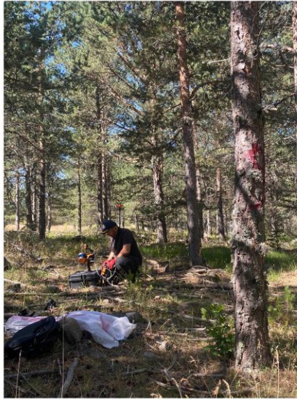
Şekil 2. ZEB-Horizon cihazı ile LiDAR veri alımı Figure 2. LiDAR data acquisition with the ZEB-Horizon device
