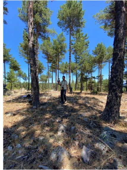
Şekil 2. ZEB-Horizon cihazı ile LiDAR veri alımı Figure 2. LiDAR data acquisition with the ZEB-Horizon device
