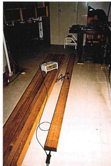
Mesure de la vitesse de propagation des ondes ultrasonores par l'appareil SYLVATEST. Measurement of propagation speed of ultrasonic waves by the SYLVATEST apparatus.
