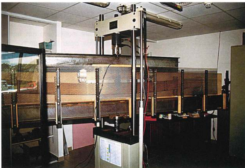
Mesure du module d'élasticité et de la résistance en flexion selon la norme NF EN 408. Measurement of the modulus of elasticity and modulus of rupture in bending as per standard NF EN 408.
