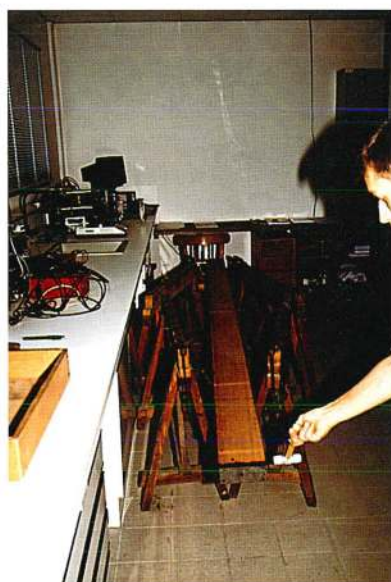
Mesure du module d'élasticité en flexion par la méthode vibratoire « Système BING ». Measurement of the elasticity modulus in bending by vibration method « BING System ».
