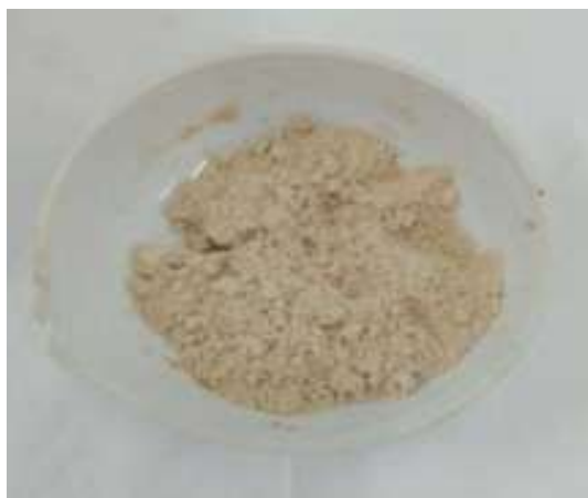
Gambar 5. Serbuk mikrokapsul hasil spray drying dari formula transfersom terbaik (Formula III) menggunakan maltodekstrin dan gom arab sebagai penyalut.
